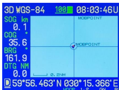
Экран «Плоттер» в режиме «Человек за бортом»
