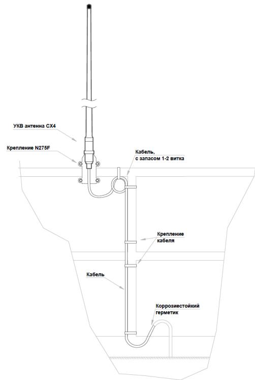
Установка антенны УКВ с креплением N275F
