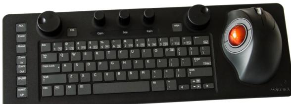
При вращении "колесика" трекбала курсор перемещается по дисплею. Устройства с трекболом имеют две кнопки, при нажатии которых выполняется то или иное действие.
