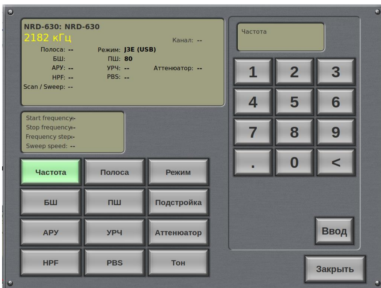
Рисунок 21. Окно настройки частоты приемника.
