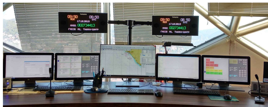
Рабочее место оператора берегового радиопункта ГМССБ порта Туапсе с использованием ПО «NAVI DSC»
